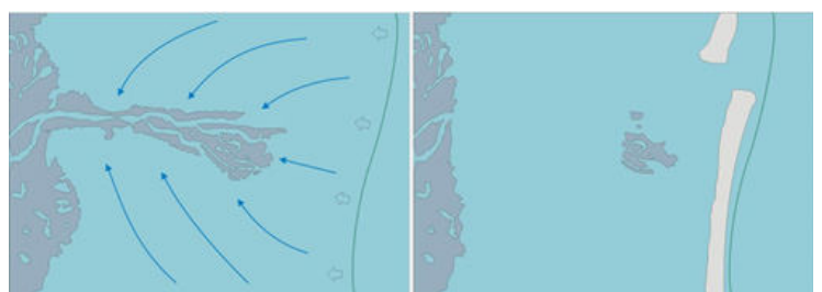
Fig. 4 - Azione morfogenetica del mare in fase di avanzamento sull'antico apparato fluviale formatosi circa 3000 anni fa durante la precedente fase regressiva (da F. Zezza, 2014)
