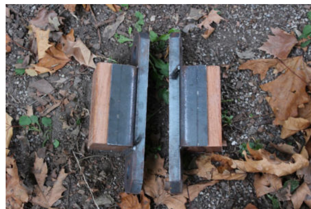
Particolare di una coppia di elementi del lato superiore delle bielle per l'ancoraggio dei tiranti. I tamponi lignei, a spigoli arrotondati e montati su spezzoni di profilato tipo UPN, sono utili ad evitare azioni di taglio sulle corde, annodate secondo le procedure della Ditta produttrice.
