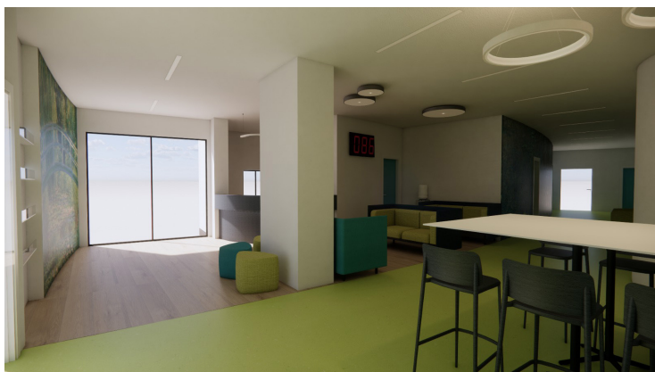
Fig. 1 - Nella sala attesa, il pavimento, in linoleum acustico durevole e sostenibile, differenzia e identifica gli spazi e le funzioni: con finitura legno alla reception, verde salvia per il corridoio
